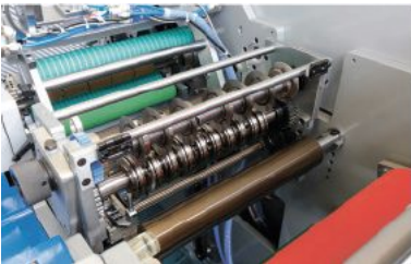
Автоматическая регулировка ножей
