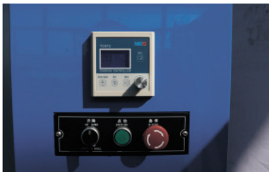
Автоматический контроль натяжения материала
